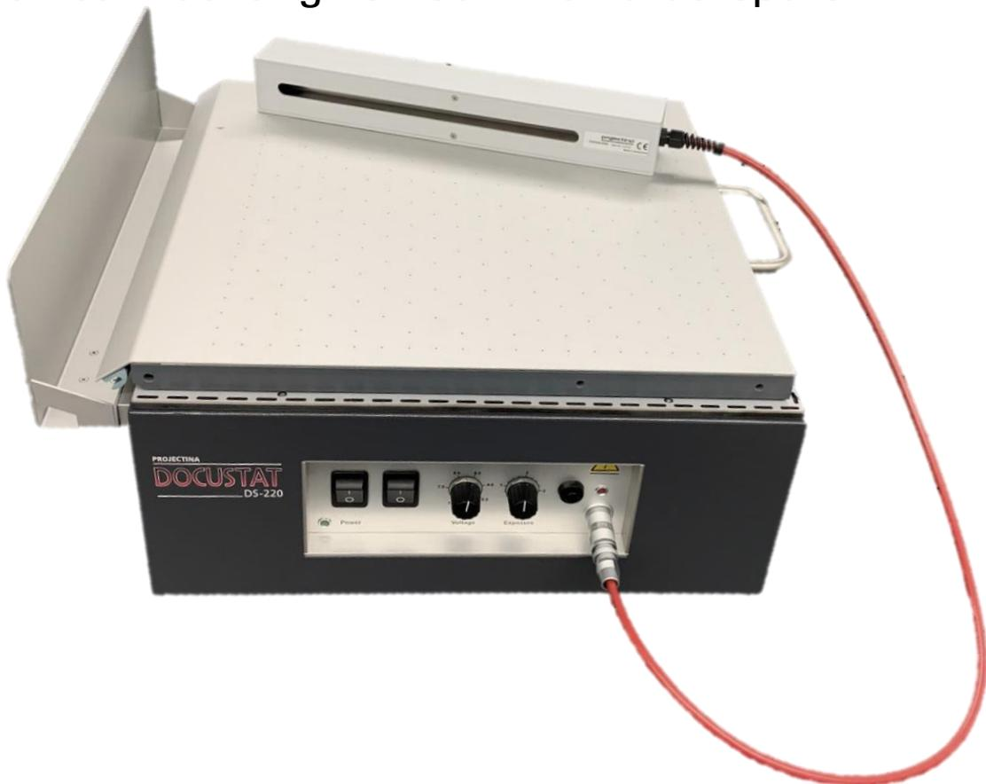
Aufgrund der recht grossen Abmessungen der Untersuchungseinheit (450x440 mm) ist das Docustat DS-220 System für kleine und grosse Untersuchungsobjekte einsetzbar. Der mitgelieferte Plastikfilm, Typ IW, erlaubt den Einsatz des Systems für verschiedene Anwendungen wie: Sicherung von Schrifteindruckspuren (Rillen) auf papierartigen Oberflächen.
